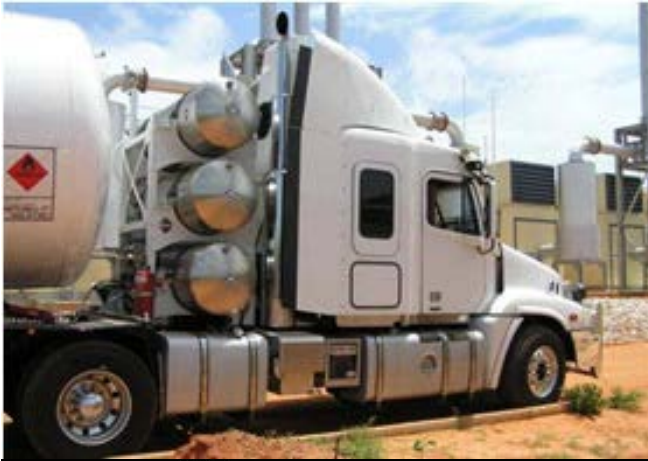
ON-BOARD LNG TANKS
